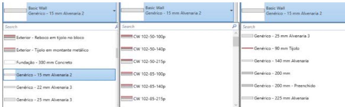
Figura 4. 11 – Biblioteca de paredes exteriores do Revit
